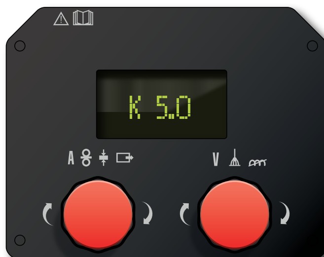
Рис. 43 – Калибровка сварочного контура со вспомогательного пульта управления ВПУ-01
